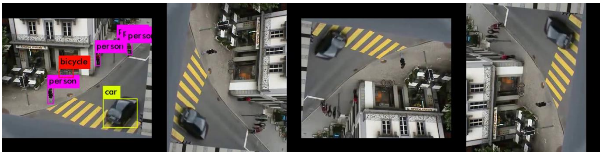
Figure 27 : Effet de la rotation sur la détection d'objets avec Yolo v3 [161].
