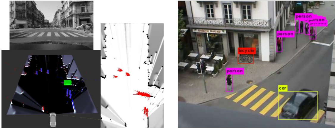
Figure 17 : Perception égo-centrique et exo-perception pour les véhicules autonomes en centre-ville. À gauche, la perception embarquée sur un véhicule autonome (source [141]). À droite, la perception distribuée dans l'environnement (source [15]) La détection d'objets est réalisée grâce au système Yolov3 [142].
