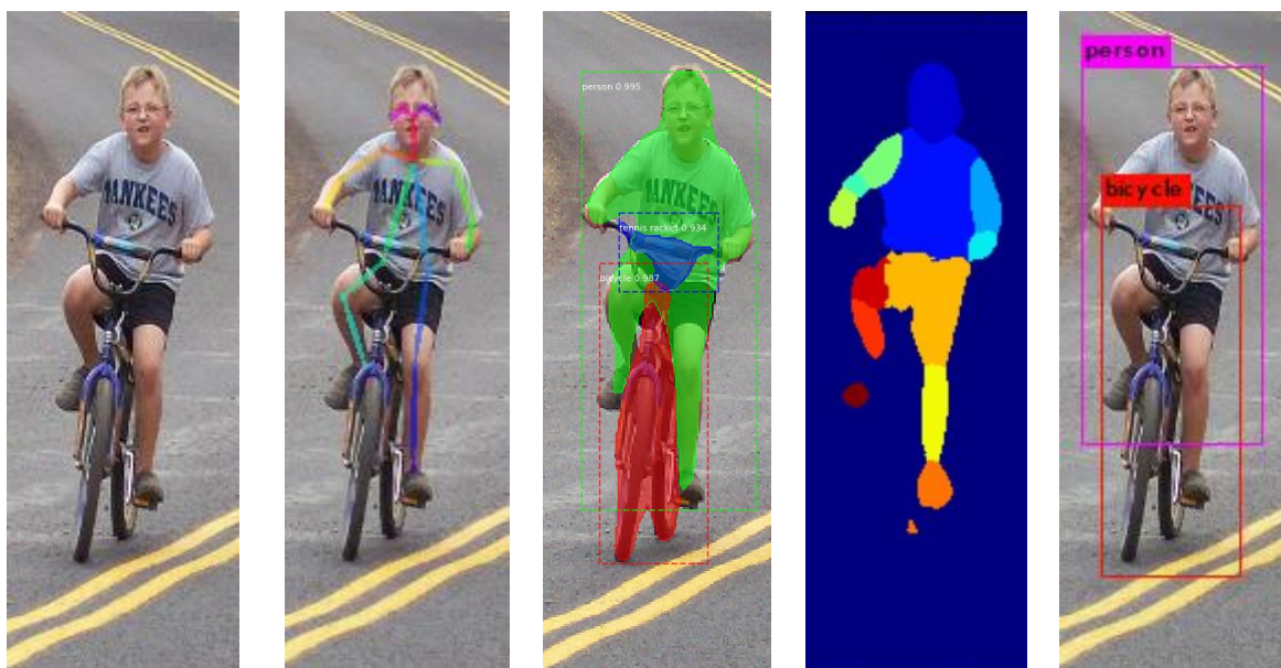
Figure 25 : Différentes approches de détection de personnes dans l’image. De gauche à droite : image originale [228], détection de points clés [225, 120, 226], détection de personne [224] et détection de parties du corps [119] pour chaque pixel, détection d’objets dans l’image [161].
