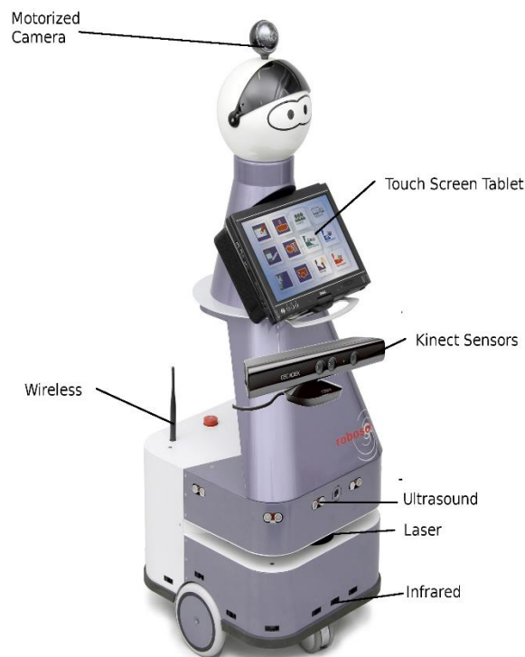
Figure 11 : Kompaï de la société Robosoft 11 , notre robot d'étude. Ce robot est équipé d'un télémètre laser, de capteurs de distance infrarouges et ultrasoniques, d'une tablette tactile et d'une webcam. Dans le cadre de nos travaux, un capteur RGBD (Kinect) a été ajouté.
