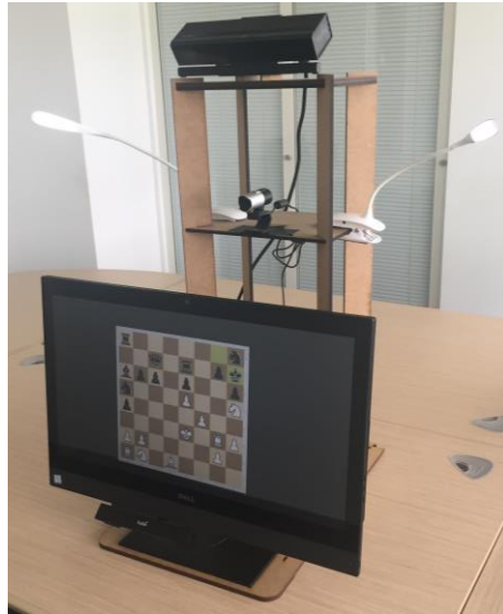
Figure 20 : Setup d'enregistrement du projet CEEGE (source [16]). Ce setup est composé d'une Kinect v2, d'une webcam, d'un écran tactile et d'un oculomètre fixe (sous l'écran). Deux lampes LED permettent de contrôler les conditions de luminosité.
