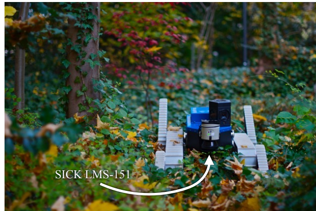
FIG. 3.5: Photographie du robot NiftiBot. Le capteur laser est monté sur l'axe pointant vers l'avant du robot et tourne alternativement à droite et à gauche de 90^\circ pour obtenir un balayage complet de l'avant du champ de vision. (Crédit Photo : François Pomerleau.)
