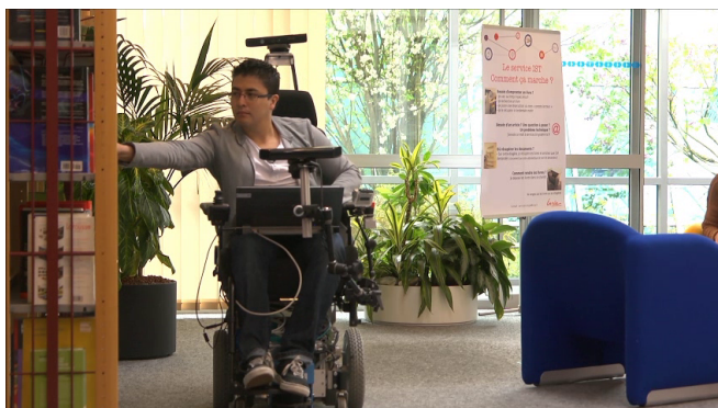
Figure 1.38: Fauteuil roulant robotisé utilisé dans nos expérimentations.
