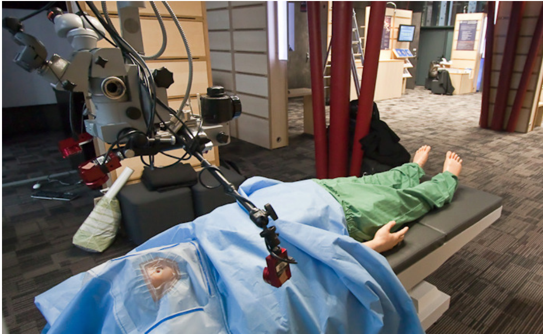
Figure 5.4 – Prototype de simulateur d’ophtalmologie comprenant un mannequin, un microscope pour effectuer la simulation des principales étapes de l’opération de la cataracte et des caméras pour l’acquisition des mouvements des outils.
