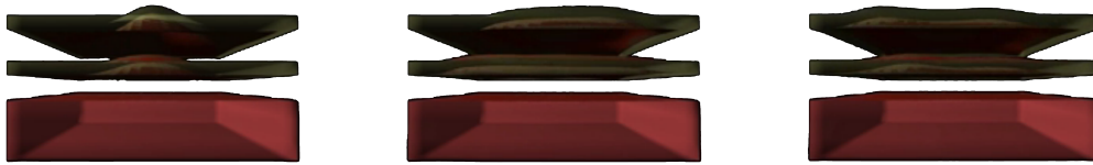
Figure 4.20 – Deux zones de fluide pour trois solides déformables. Les couches de solide et de fluide sont placés alternativement. Seuls les solides sont visibles. Les images montrent le déplacement de la membrane au cours du temps en fonction de la pression exercée par le fluide. On voit ainsi sur la première image, l’effet du fluide qui vient juste d’être injecté ; puis en seconde image, le fluide s’étendant formant une vague ; et enfin en dernière image le retour de la vague.
