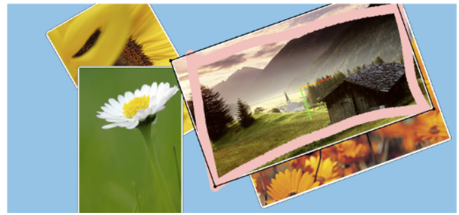
Fig. 7. Capture d'écran de l'application illustrant l'utilisation du calcul de matrice d'inertie pour la détermination de boîte englobante orientée. Le rectangle rose est dessiné par l'utilisateur avec un doigt posé initialement sur l'arrière plan de l'application (en bleu). Ce rectangle est alors reconnu par l'application grâce au système de reconnaissance de gestes. L'ensemble des points du rectangle dessiné par l'utilisateur est utilisé, après rééchantillonnage, pour le calcul de la matrice d'inertie et celui des vecteurs propres (en rouge et vert). Le vecteur correspondant à la direction principale (rouge) est choisi (orange). Dans le repère orienté correspondant, les valeurs minimales et maximales en abscisse et ordonnée permettent d'obtenir les dimensions de la boîte englobante pour ensuite l'afficher (rectangle noir). Une image, redimensionnée à celle du rectangle noir, est enfin affichée à la place de ce rectangle.
