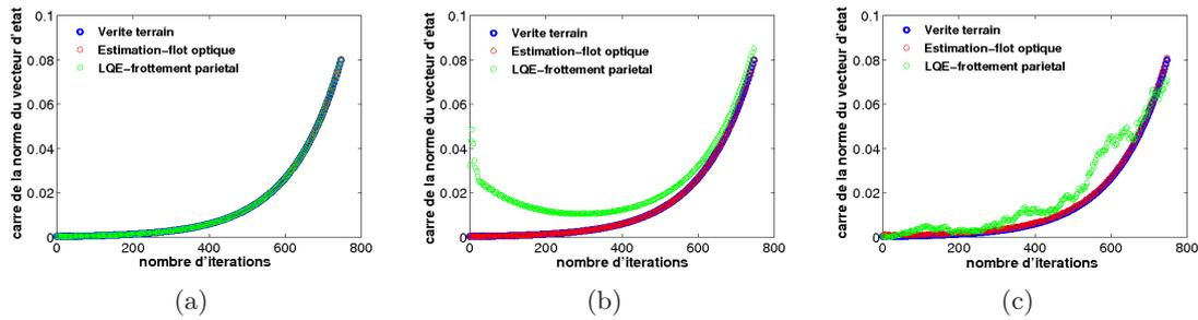
FIG. 2 – Comparaison de l’estimation du vecteur d’état en utilisant le frottement pariétal et le flot optique : (a) cas idéal, (b) mauvaise initialisation  $\widehat{\mathbf{p}}^n(0) = 10\mathbf{p}^n(0)$  dans l’estimateur LQE et (c) bruit blanc Gaussien d’écart type 0.01 pour le frottement pariétal et  $\widehat{\mathbf{p}}^n(0) = \mathbf{p}^n(0)$  pour l’estimateur LQE et bruit blanc Gaussien d’écart type 0.1 en chaque élément du champ de vitesses mesuré par flot optique.
