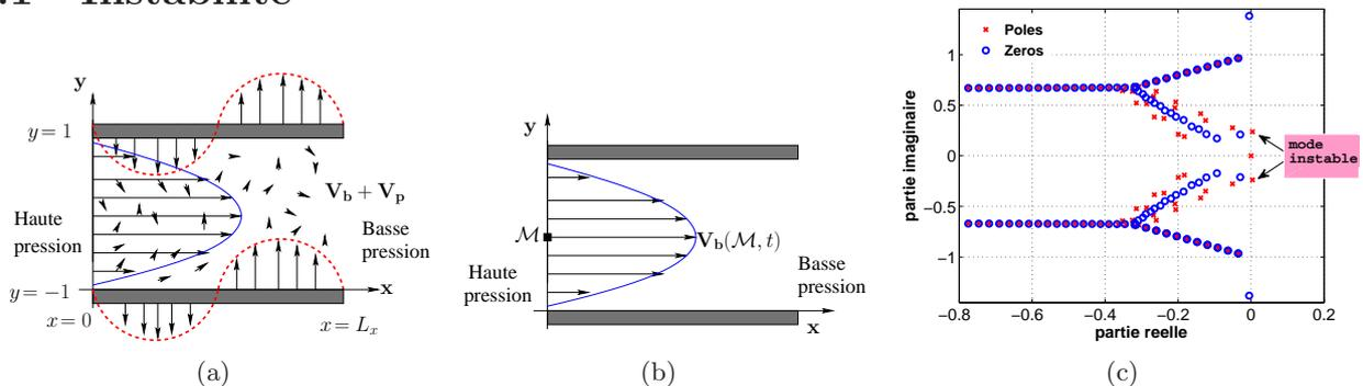
FIG. 1 – Commande aux frontières d'un écoulement perturbé 2D plan de Poiseuille : (a) Commande aux frontières de l'écoulement de base  $\mathbf{V}_b(x, y, t)$  perturbé par  $\mathbf{V}_p(x, y, t)$  avec  $L_x$  la longueur d'une période dans le sens de l'écoulement, (b) profil de vitesses de l'écoulement stationnaire où  $\mathcal{M}$  est un point de l'écoulement et (c) pôles et zéros du système linéarisé réduit pour  $Re = 10\,000$ ,  $\alpha_n = 1$ .
