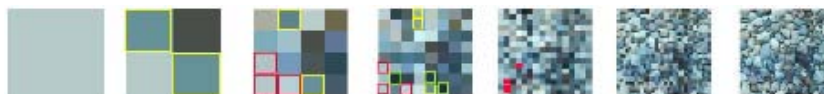
FIG. A.3: Hypothèse de De Bonnet [6] : en dessous d'une certaine résolution, la permutation de certaines régions est indiscernable (régions encadrées).
