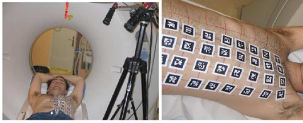
FIGURE 1 – Système d’acquisition pour le suivi de la peau avec marqueurs [3].
