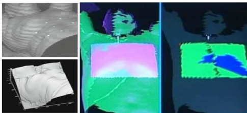
FIGURE 2 – Suivi utilisant la lumière structurée [7] et système d’acquisition AlignRT®.
