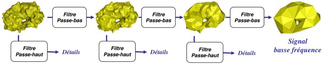
FIGURE 1 – Principe général de l'analyse multirésolution.
