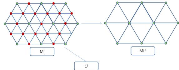
FIGURE 3 – Transformée en ondelettes d'un maillage semi-régulier.  $M^j$  est décomposé en un maillage "basse fréquence"  $M^{j-1}$  et un ensemble de coefficients  $C^j$  (associés aux sommets rouges supprimés durant la décomposition).
