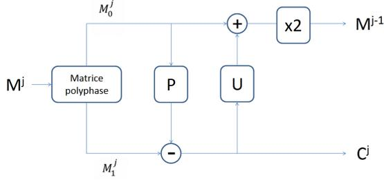
FIGURE 4 – Schéma lifting pour maillages semi-réguliers.
