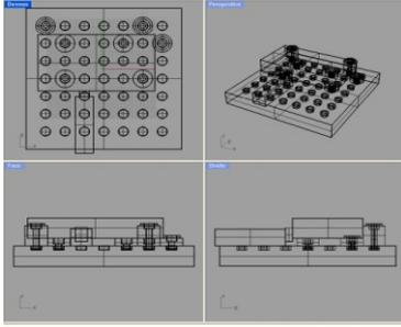
**Figure 2** : Modèle CAO de montage d'usinage
