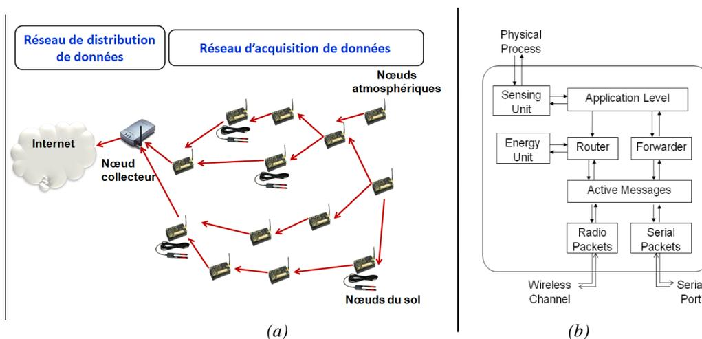
Fig.1 : (a) L'architecture globale du réseau (b) l'architecture logicielle
