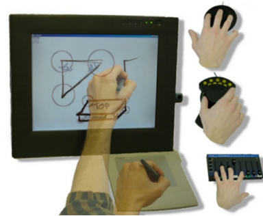
Figure 2: Un exemple de configuration de notre système. Associations implicites avec différents périphériques d'entrée.
