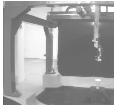
FIG. 14 – La sphère de vues est obtenue au moyen d'une caméra embarquée sur un bras robotique.
