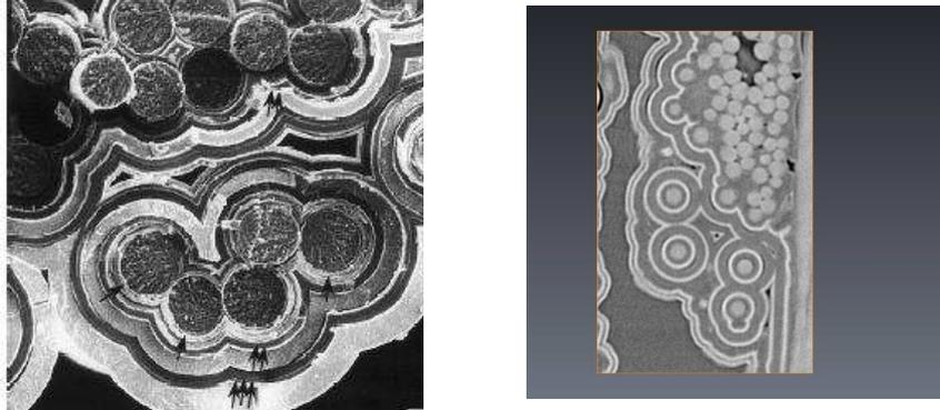
Figure 1: Matériaux composites réels; observation des différentes couches de matrice superposées autour des fibres.
