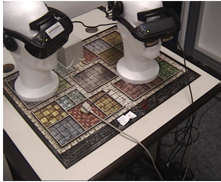
FIG. 8 – Configuration de test. On peut noter le stylo équipé du capteur (en premier plan), le casque semi-transparent également équipé d'un capteur (sur la droite) et le casque virtuel opaque (sur la gauche). L'interaction se fait sur le plateau de jeu.
