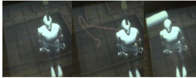
FIG. 12 – Déplacement d’un pion avec la méthode “push and stop”. l’utilisateur peut définir une trajectoire pour le pion (déplacement différé sur vignette 2), et un mouvement vertical termine la sélection du pion qui se place alors à la position fixée (on peut l’animer le long de la trajectoire).
