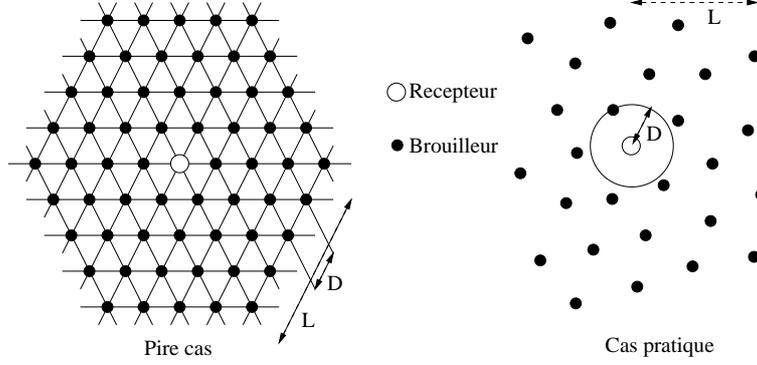
FIG. 1 – Deux situations où les émetteurs sont à distance au moins  $D$  les uns des autres, avec  $L$  la distance du brouilleur le plus éloigné dans le réseau. À gauche, un “pire cas” (maillage dense), à droite, une situation pratique.
