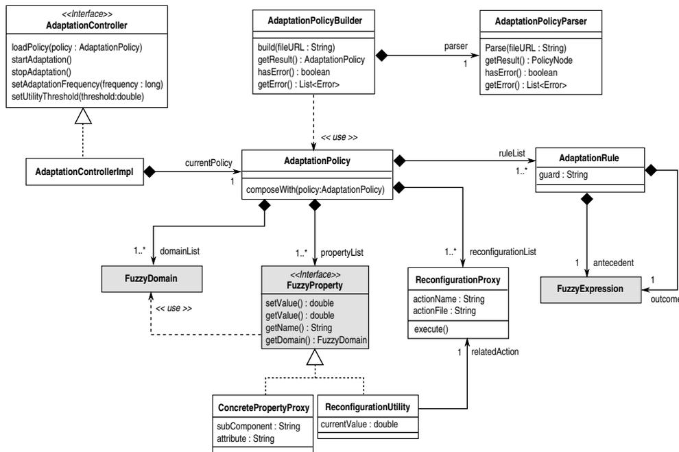
FIG. 4 – Conception détaillée du contrôleur d'adaptation pour Fractal
