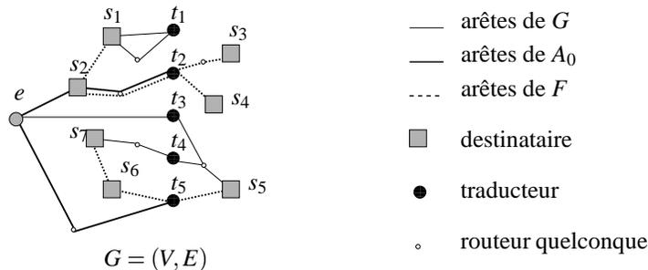
**FIG. 1** – Construction d'une solution dans le graphe  $G = (V, E)$  de coût 14 pour notre problème avec  $\lambda = 1$  et  $\mu = 1$  (les arêtes sont toutes valuées à 1). Les traducteurs utilisés sont  $t_2$  (relié à  $s_1, s_2, s_3,$  et  $s_4$ ) et  $t_5$  (relié à  $s_5, s_6$  et  $s_7$ ).
