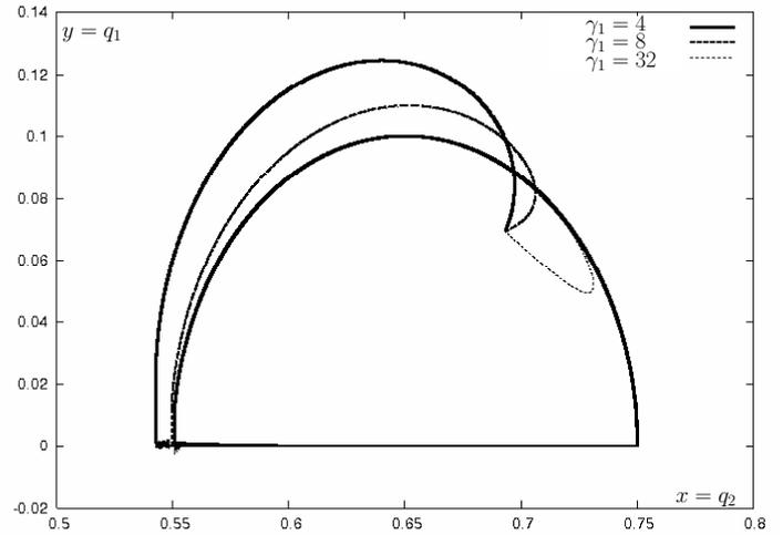
(b) Simulation de la poursuite de la trajectoire en fonction d'un gain de la commande  $\gamma_1$ .
