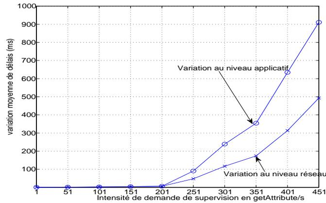
**Figure 9.** Variation moyenne des délais de la supervision du serveur Web TJWS sous différentes intensités de demande de supervision.
