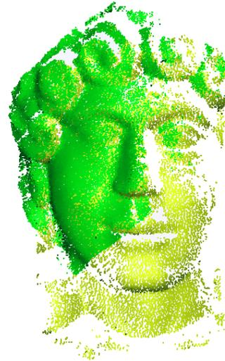
FIGURE 5 – Deux nuages de points recalés par ICP
