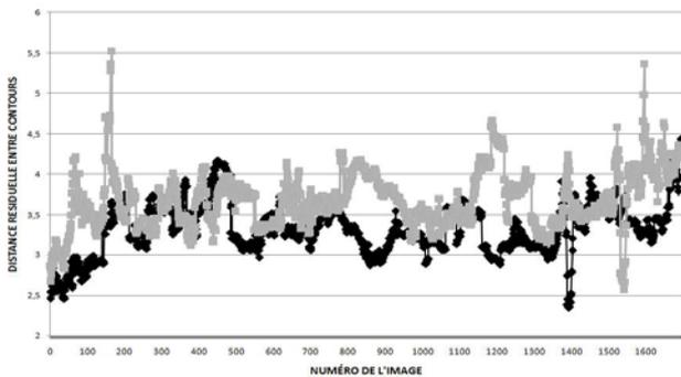
**Figure 6 :** Distance résiduelle entre contours obtenue par le recalage sur les régions (en gris) et recalage sur les contours (en noir). Les recalages incorrects apparaissent comme des pics de la distance résiduelle entre contours.
