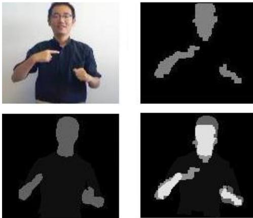
**Figure 3 :** Précision limitée du recalage sur les régions : les images sont respectivement l'image acquise, puis segmentée, la projection du modèle 3D et enfin la superposition de la projection du modèle avec l'image segmentée. La pose du modèle 3D diffère de celle de l'acteur observé car le recalage sur les régions n'est pas précis.
