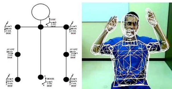
*Figure 2 : Notre modèle 3D de la moitié supérieure du corps humain avec ses 20 degrés de liberté, puis ce modèle maillé superposé à l'acteur pour ajuster la morphologie du modèle sur une image initiale.*
