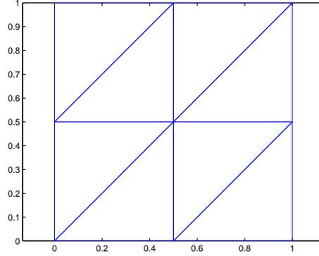
FIG. 9 – Maillage initial pour tester les méthodes multigrille.
