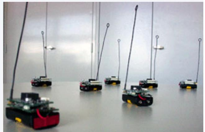
Les capteurs communiquent entre eux grâce au modèle de pair à pair.
