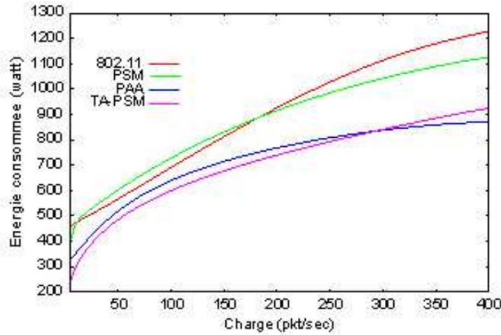
Figure 22: Energie consommée en fonction de la charge
