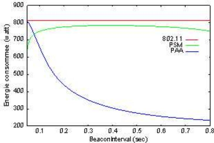
Figure 32: Energie consommée en fonction du BeaconInterval
