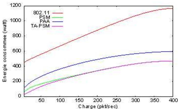
Figure 18: Energie consommée en fonction de la charge
