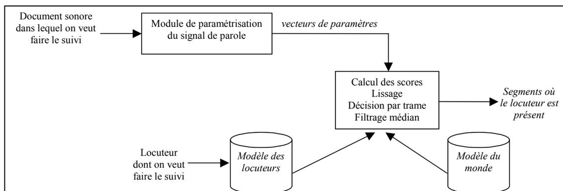
Figure 6 : Représentation modulaire de la phase de suivi d'un locuteur.
