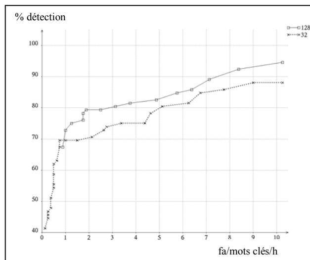
Figure 12: Courbe ROC présentant les résultats de la détection des mots clés : taux de détection par fausse alarme/mot clé et par heure
