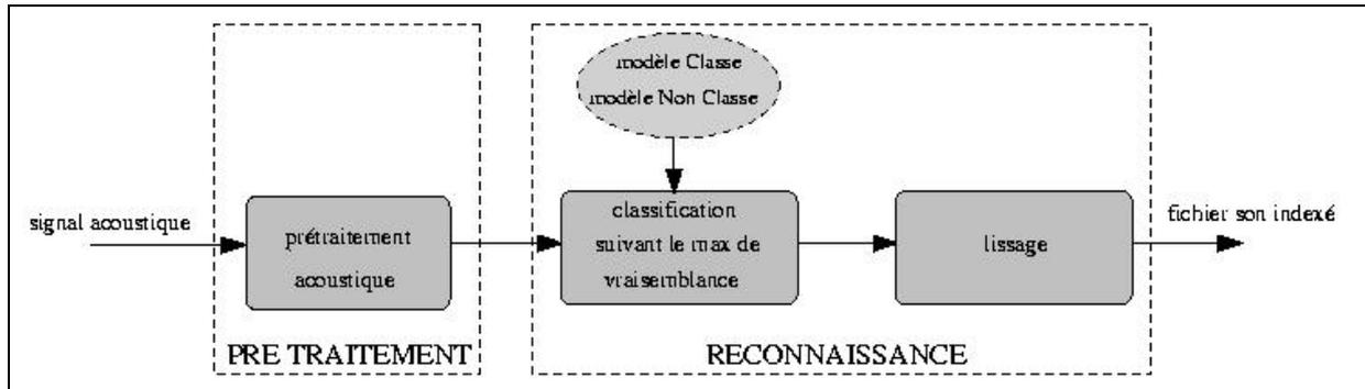
Figure 2 : Schéma général du système d'indexation
