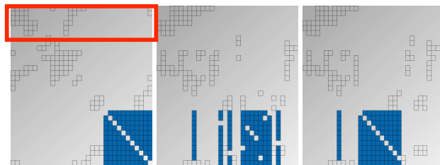
Figure 5 : A gauche matrice initiale. En rouge sous-matrice à réordonner, en bleu groupe à conserver. Au milieu sans blocage, à droite avec
