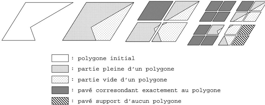
FIG. 3 – Exemple de maillage d'un polygone concave.
