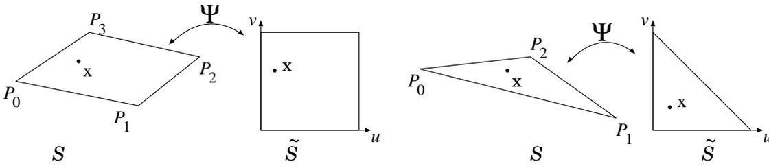
FIG. 1 – Transformations entre les coordonnées réelles et normalisées.
