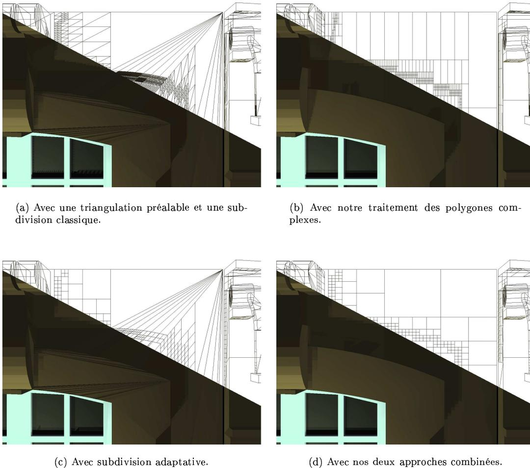
FIG. 8 – Exemples de maillage et solution de radiosité.
