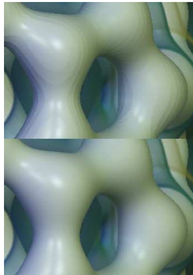
FIG. 16 – Visualisation d'une molécule sans pré-intégration (en haut) et avec pré-intégration (en bas) d'après [LWM04]. Les artefacts liés à la découpe ne sont plus visibles dans le deuxième cas.
