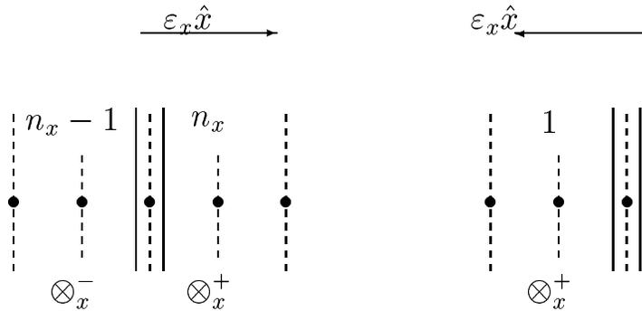
FIG. 3 – Numérotation pour le maillage sur l'arête en  $x$  contenant le coin. La numérotation du bas est adaptée au schéma pour le coin. La numérotation du haut correspond aux indices réels des fonctions d'arête. On distingue deux cas selon que le coin est au début ou à la fin de l'arête.
