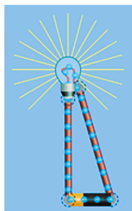
Inversion de polarité de la pile
