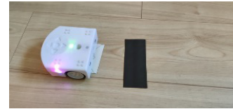
Le robot Thymio redémarre lorsqu'on pose le courrier sous les capteurs. Il faut tenir du doigt le courrier, sinon, il est entraîné par le robot à son départ (comme sur la photo).
