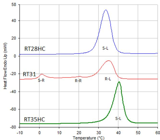
Figure 4 : Thermogrammes des paraffines en masse lors de chauffe à 10°C.min<sup>-1</sup>
