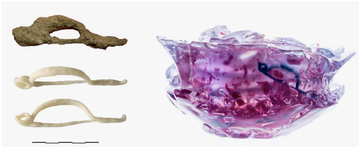
Figure 2. Gauche : La fibule extraite de l'urne et sa copie en impression 3D. Droite : Impression complète de l'urne en transparence.
