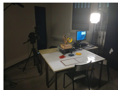
FIGURE 2: Un exemple de dispositif d'expérience en laboratoire. Le sujet est placé devant la lampe et est filmé par une caméra.
