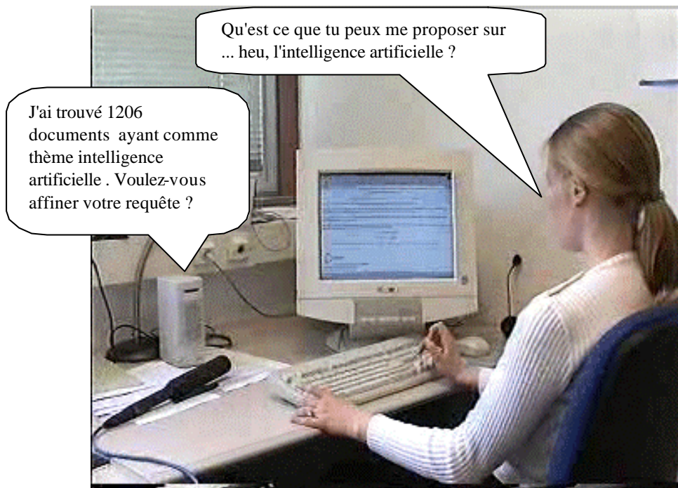
Figure 1. L'utilisateur dialogue avec le système HALPIN. Il énonce (dans cet exemple) sa demande oralement et le système lui répond sur le même mode. La réponse est coopérative : c'est ici une proposition d'affiner la requête pour restreindre le nombre de documents trouvés.
