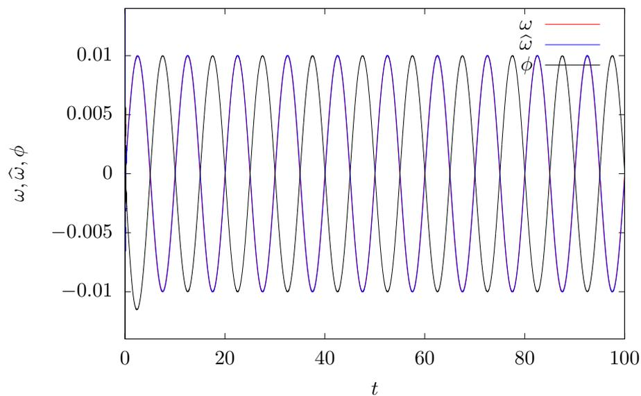
FIGURE 12 – Évolution de l'amplitude du signal de commande, du signal de perturbation et de son estimé dans le cas de la couche de mélange spatiale.
