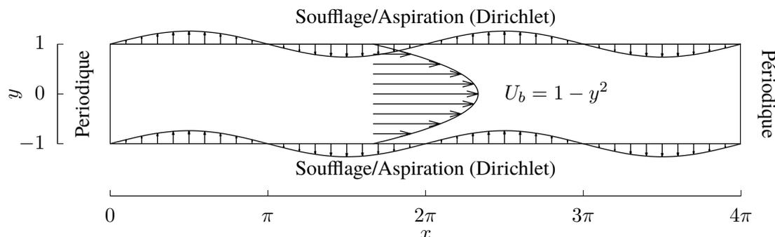
FIGURE 1 – Illustration de l'écoulement de canal périodique.
