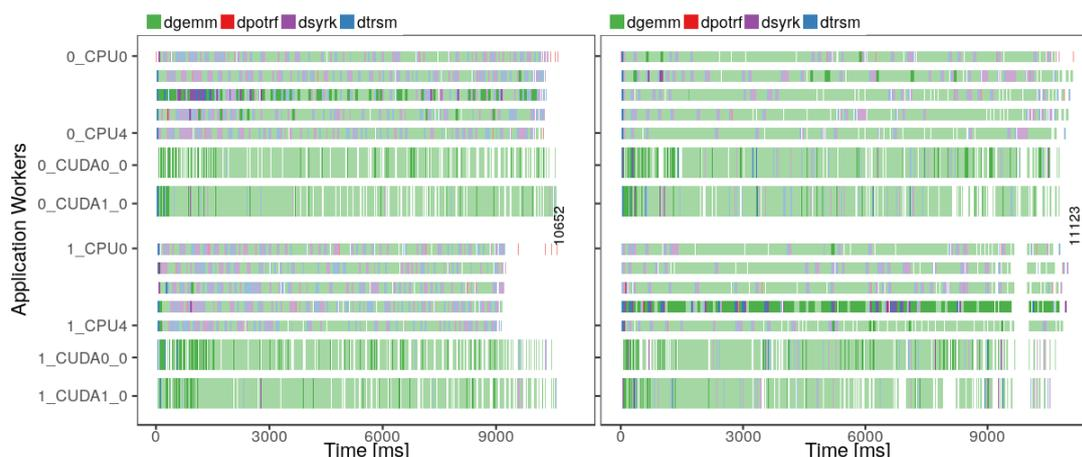
**Figura 4. Execuições da fatoração de Cholesky em dois nós após as modificações no StarPU. Matriz com 35×35 blocos de 960×960 utilizando os escalonadores DMDAS (painel da esquerda) e LWS (direita) e P=1.**
