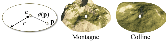
Figure 5: Les primitives disques définissent le relief dans des zones circulaires. Plusieurs fonctions d'élévation peuvent être utilisées : une fonction constante donnera une plaine, une turbulence produira des collines et une fonction de bruit ridge-multifractals [MKM89] imitera des montagnes.
