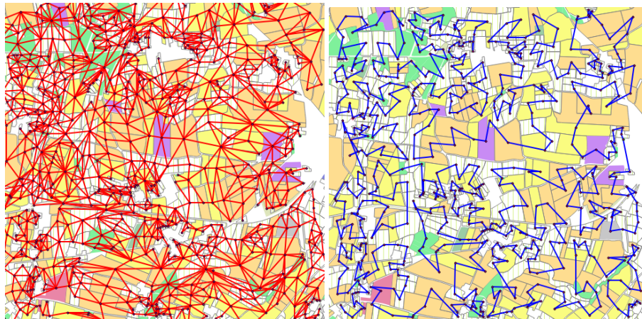
FIG. 5 – À gauche : graphe de connectivité d'une sous-zone ; à droite : chemin de Hilbert Adaptatif sur la même sous-zone
