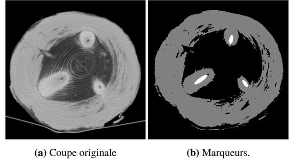
**Figure 6.** Initialisation des marqueurs pour les algorithmes PW, KR et PR. L'arrière-plan est marqué en noir et les nœuds en blanc. Ces algorithmes permettent d'associer chaque pixel gris à l'arrière-plan ou à un nœud.
