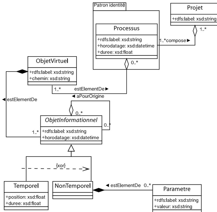
FIGURE 2 – Patron de montage réalisé en UML.
