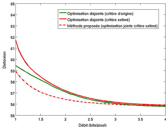
FIG. 3 – Comparaison de l’optimisation disjointe du critère d’origine (4) et son estimation (9) avec la courbe débit-distorsion de l’optimisation jointe du critère estimé (9) sur l’image *Lena*,  $\sigma_z = 15$ .
