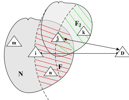
Figure 15: Exemple de routage avec voisinage à 2-sauts
