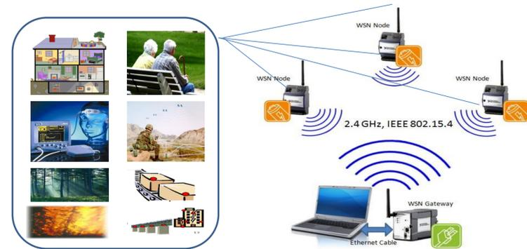
Fig.1 : Architecture d'un RCSF et applications.
