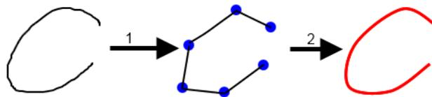
**Figure 3.** Création du prototype par approximation polygonale puis Spline.
