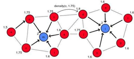
**FIGURE 2:** Les nœuds calculent alors leur densité (valeur sur le schéma) et la transmettent à leurs voisins. Ils s'attachent au nœud de plus forte densité dans leur voisinage ou deviennent *cluster-heads* s'ils détiennent la plus forte valeur.
