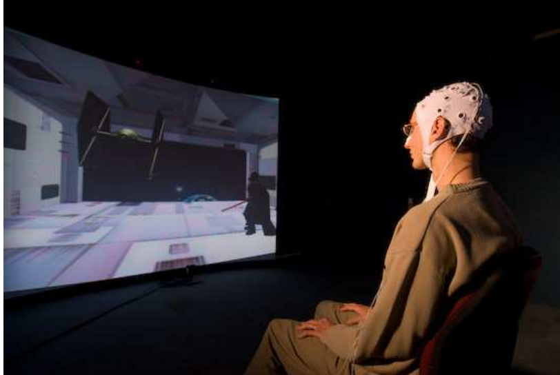
Figure 5. L'application ludique "Utilisez-la-force" permettant de déplacer un vaisseau spatial virtuel grâce à son activité cérébrale (copyright Hubert Raguet/Photothèque CNRS)
