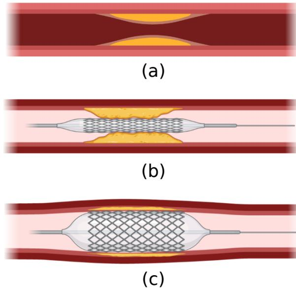
FIGURE 1.7 – Principe de l’angioplastie avec pose d’un stent : (a) artère sténosée; (b) ballon (avec un stent) avant qu’il soit gonflé; (c) artère une fois le ballon gonflé. (Schémas créés à partir de BioRender<sup>6</sup>)
