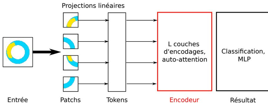
FIGURE 2.9 – Représentation schématique du transformeur ViT. Les données sont segmentées en patches, puis projetés pour former des *tokens*, qui sont ensuite encodés par un module basé sur de l'auto-attention, puis utilisés pour la tâche visée (par exemple, de la classification).
