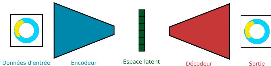
FIGURE 2.8 – Schéma de fonctionnement de l'auto-encodeur. Les données d'entrée (à gauche, de dimension  $D$ ) sont progressivement encodées dans un vecteur de faible dimension (en vert, de dimension  $d$ ), puis reconstruites par le décodeur. L'espace latent pour l'ensemble de la population est donc de dimension  $N \times d$ .
