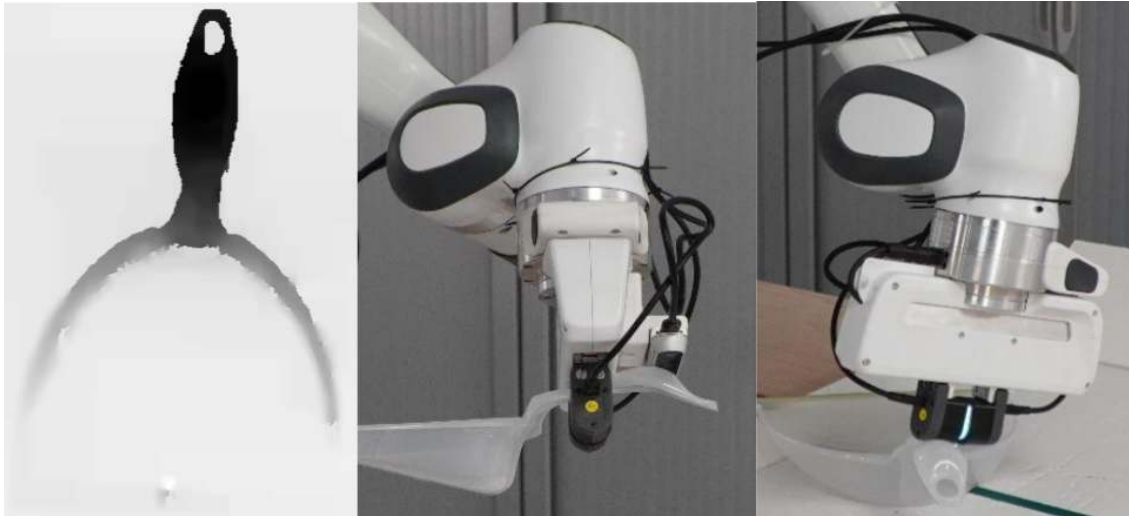
FIGURE 4.1 – Problème typique des saisies planes : la hauteur du centre de saisie est souvent fixée par une heuristique basée sur la surface la plus haute. Si la forme de l’objet est inconnue, cela peut conduire à des saisies infructueuses. À gauche, une image en échelle de gris d’un objet générée à partir du nuage de points capturé par la caméra RGB-D montée sur l’effecteur du robot. Au centre et à droite, deux saisies descendantes générées par Dex-Net [108] et GPD [136], deux générateurs de saisie classiques. La prise de Dex-Net au centre est trop basse, l’objet n’est pas saisi par les mâchoires de la pince, tandis que la prise de GPD à droite est trop haute pour être réussie (en raison de la forme arrondie du manche, l’objet glisse et est poussé vers le bas lors de la fermeture de la pince). Sans connaissance préalable de l’objet et de son épaisseur, une mauvaise prédiction de la hauteur peut conduire à l’échec.
