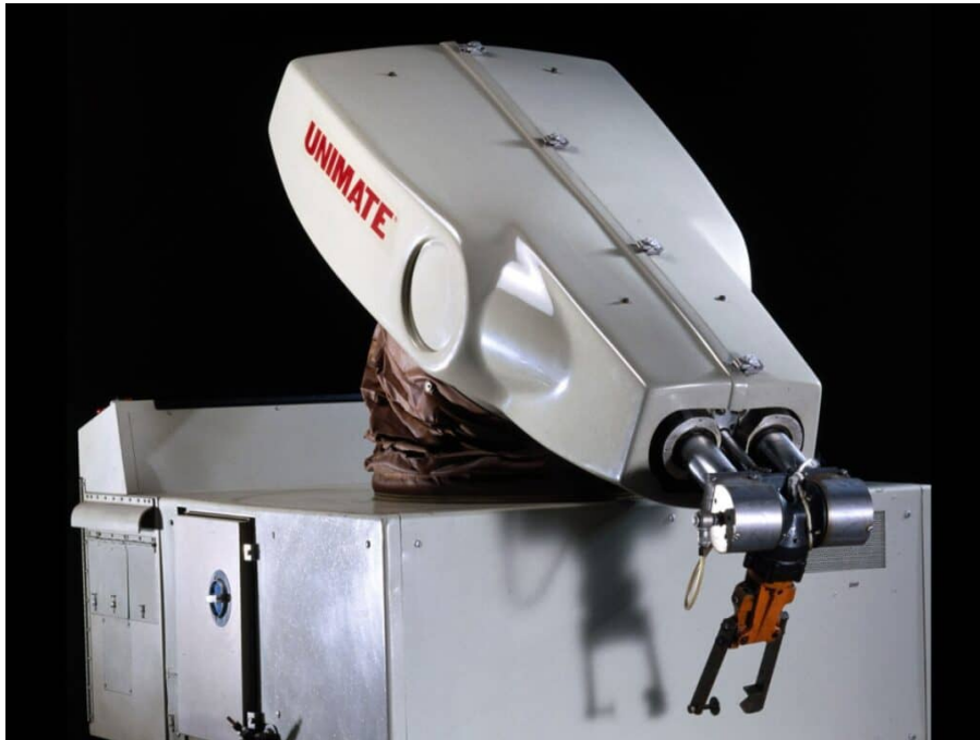
FIGURE 1.2 – L’Unimate était le premier robot industriel jamais construit. C’était un bras manipulateur hydraulique qui pouvait effectuer des tâches répétitives.
