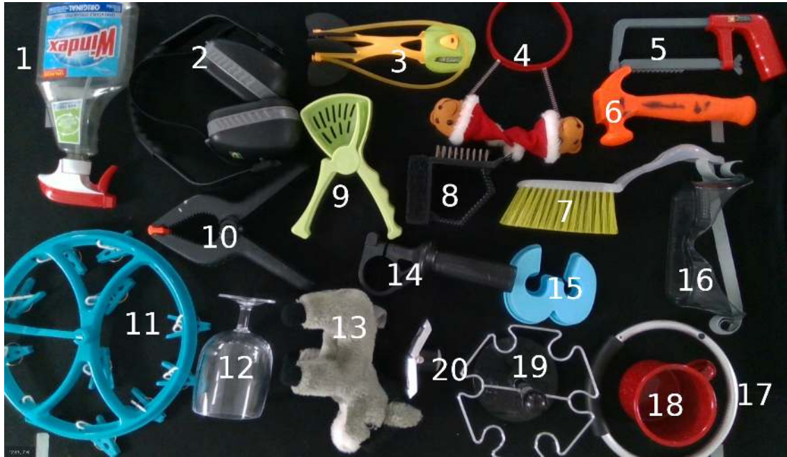
FIGURE 3.12 – Nous avons sélectionné ces objets selon plusieurs critères. Ils doivent présenter de multiples configurations de pose stables pour pouvoir être disposés sur une table. Ils doivent également permettre des prises distinctives et spécifiques, par exemple les outils ou les couverts qui doivent être saisis par le manche, les jouets par certaines parties, les bouteilles par leur bouchon, etc... De plus, nous avons veillé à choisir une variété d'objets de différentes tailles, formes et couleurs. Enfin, certains de ces objets présentent des caractéristiques particulières, comme le fait d'être transparents, déformables ou articulés.
